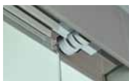
2 Sensorik für Querschieber- erfassung
